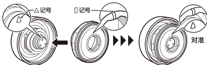
②按箭头方向旋转中栓，将上盖的下一个△记号对准中栓的□记号。
